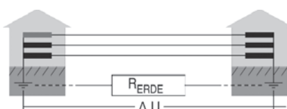
Poteinzialdifferenzen durch Erdschleifen
